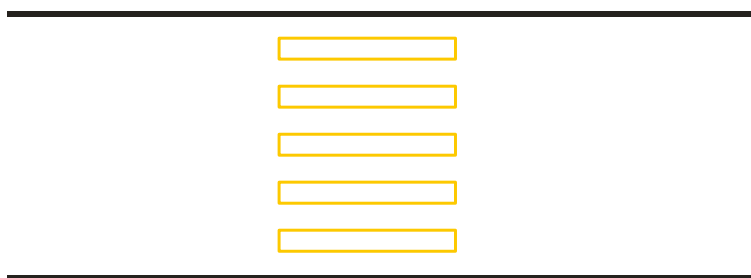
Obr. 38: Příklad VDZ přechodu pro chodce vyznačený obrysem značky č. V 7.
